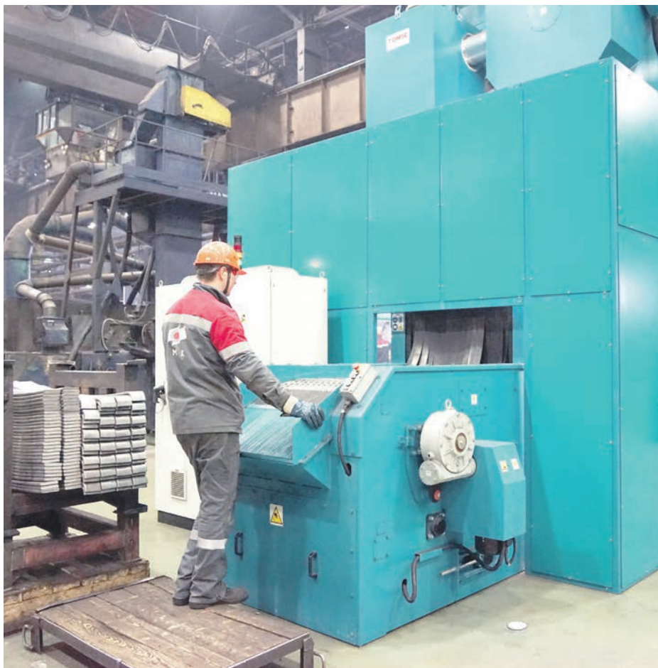
▲ Одна установка заменит два дробемета © ЮРИЙ СОФОНОВ
